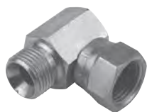
BSP male 60° binnenconus voor bonded seal/BSP female swivel 60° buitenconus
