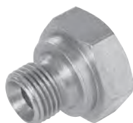
Plug met zeskant kop - BSP male 60° binnenconus DIN 3852 Form A
