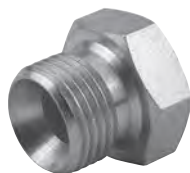
Plug met zeskant kop - BSP male 60° binnenconus
